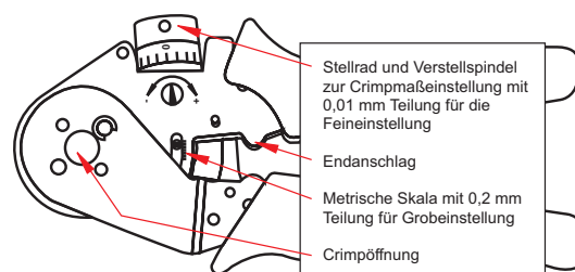
Bild 7 Crimpöffnung und Skala an der Crimpzange (Vorderseite)
