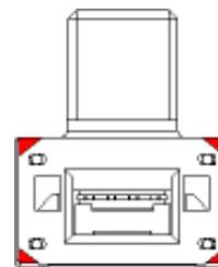
Bild 5 Gehäuseunterseite stand-off area
