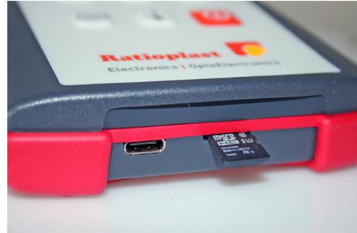
Bild 8 USB-Schnittstelle und microSD-Kartenslot
