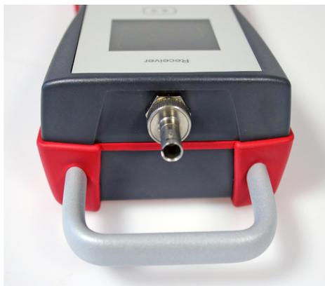
Bild 3 Detektor mit Wechseladapter
